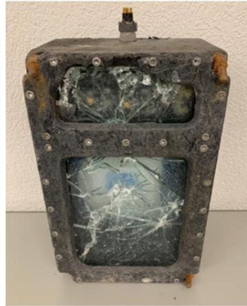
**Hart im Nehmen:** Kameragehäuse wurde von der Felswand bei einem Murgang abgerissen und unterhalb des Installationsortes aus dem Geschiebesammler geborgen. Gehäuse und Sicherheitsglas stark beschädigt aber kein Eindringen von Wasser in das Gehäuse, das Kamerasystem ist in einem neuen Gehäuse wieder im Einsatz.
